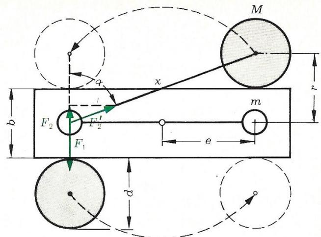
Kraft  $2F$ , einmal vom verdrillten Faden her, zum anderen von der Anziehungskraft der großen Kugeln. Unter Einfluß dieser Kraft  $2F$  führen die kleinen Kugeln eine beschleunigte Bewegung aus. Wir wollen die Kraft als konstant annehmen (in Wirklichkeit nimmt sie, wie wir sahen, ab), um die Rechnung einfacher zu gestalten. Im Anfang der Bewegung ist dies genähert der Fall. Die Beschleunigung ist dann nach der mechanischen Grundgleichung  $a = 2F/m$ . Der zurückgelegte Weg wird
